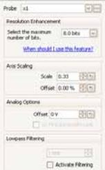
Die Kanalooptionen bieten Zugriff auf kanalspezifische Einstellungen wie benutzerdefinierte Messfühler, Verbesserung der Genauigkeit, Offset-Steuerung und Filterung.
