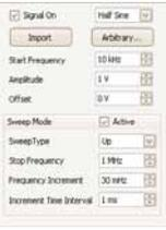
Funktionsgenerator: Dient zur Erzeugung von Standardsignalen oder benutzerdefinierten Wellenformen. Beinhaltet Optionen zur Frequenzabstimmung.
