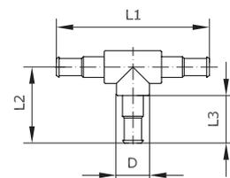
**Y-Stecknippel-Verbindung aus Messing und Kunststoff**
