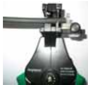
Câble contre la butée d'arrêt
