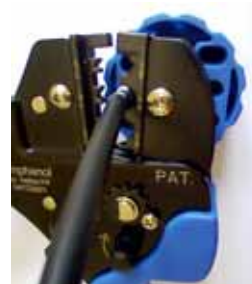
Krimpzange mit Kontakt eingeführt
