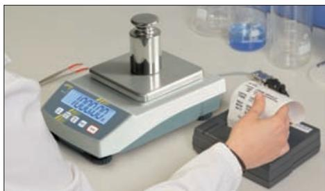
**Création de protocoles BPL/ISO** des données de pesage, ajustage des balances, etc. avec la date, l'heure et le n° d'identification. Idéal pour la surveillance et la documentation des processus dans le cadre d'un système
