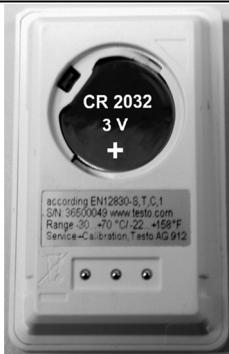
3. 正确插入提供的电池（3 V 钮扣电池，CR 2032 锂电池），使 + 极始终可见。
