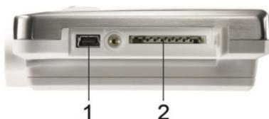
5. Inserire il cavo USB nell'attacco Mini-USB (1).
