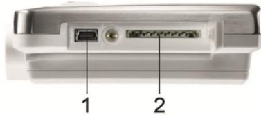
4. Inserire il cavo USB nell'attacco Mini-USB (1).
