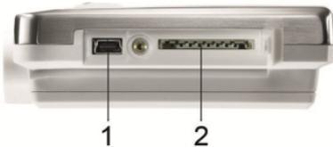
3. Inserire la scheda SD nel lettore di schede SD del data logger (2).
