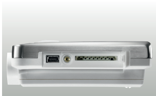
Seitlicher Anschluss von Mini-USB-Kabel und SD-Karte
