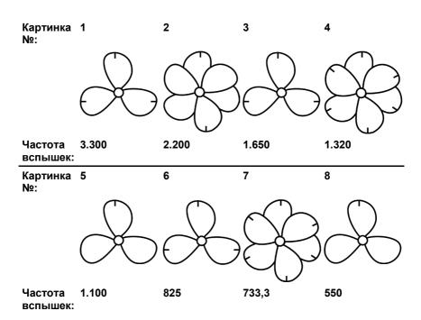
Ориентировочная метка позволяет увидеть, что картинки при частотах 3.300, 1.650 и 825 об/мин представляют собой мультиплицированные гармоники. В каждом из этих случаев видны три идентификационные метки. С другой стороны "единичные" картинки можно наблюдать при частоте 1.100, а также при частоте 550.
