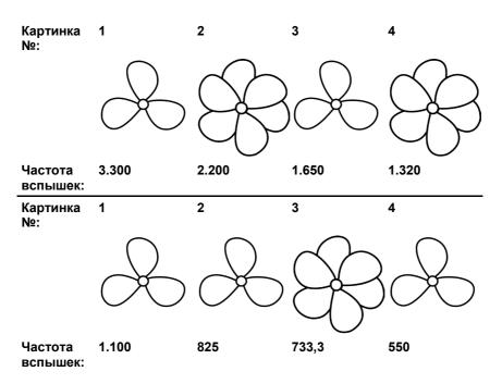
Какова фактическая скорость крыльчатки? 1, 3, 5, 6 и 8 — "фиксированные" картинки, таким образом, значения скорости можно принять за 3.300, 1.650, 1.100, 825 и 550.
