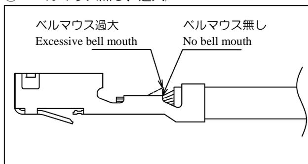
工具の調整状態や、工具への端子のセットの仕方により発生する事が有ります。ベルマウスが無かったり大き過ぎる事により、芯線の断線や引っ張り強度の不足、電氣的接続の不安定となる恐れがあります。
