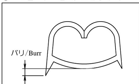
工具の調整状態やクリンパ、アンビルの摩耗、傷が有る時、発生する事があります。バリが著しかったり著しく左右が不均一な事によりバリ部での端子の亀裂や、電氣的接続の不安定、強度不足、端子の変形となる恐れがあります。
