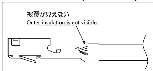
電線のストリップ寸法が不適切だったり、工具への電線のセットの仕方により発生する事が有ります。
