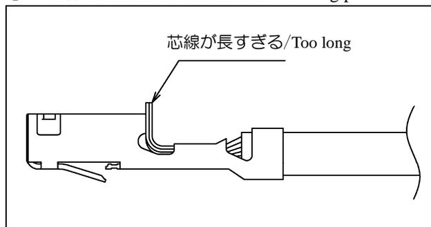
電線のストリップ寸法が不適切だったり、工具への電線のセットの仕方により発生する事が有ります。突き出しが長過ぎる事によりコンタクトの接触障害となったりハウジングへの挿入不完全となる恐れがあります。
