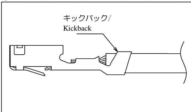
工具に適合しない電線を使用した時に発生する事があります。
