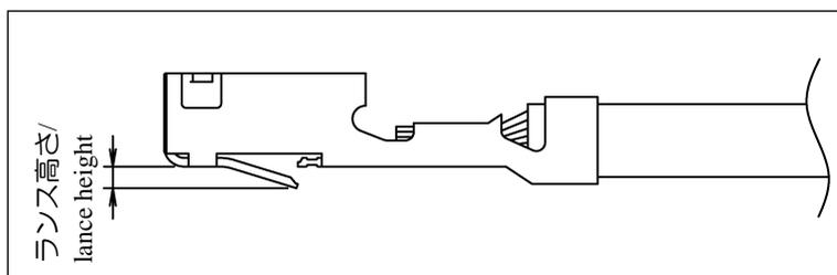
圧着した端子のランスの高さが所定の寸法内にあるか確認してください。
