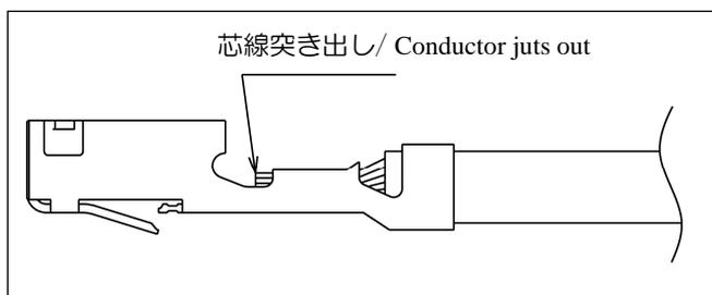
適正なストリップ長さ：圧着した際、ワイヤーバレル先端から芯線が突き出しており、また被覆がインシュレーションバレルより引っ込んでいたりワイヤーバレル内に入り込んでいない状態であること。
