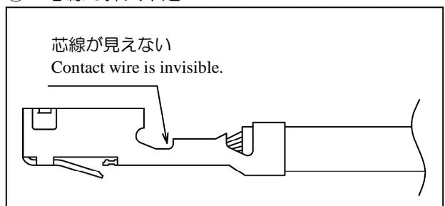
電線のストリップ寸法が不適切な時に発生する事が有ります。
