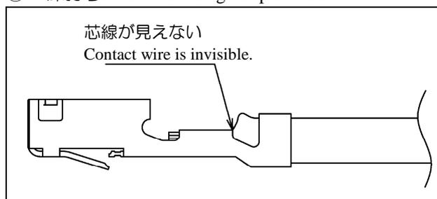
電線のストリップ寸法が不適切だったり、工具への電線のセットの仕方により発生する事が有ります。
