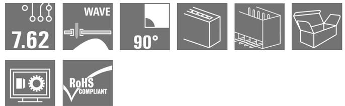
Einreihige Hochstrom- und High Performance Stiftleisten, polverlustfrei anreihbar oder mit patentiertem Flansch zur schnellen, werkzeuglosen Verriegelung. Höchste Bedienungs- und Betriebssicherheit durch 100% fehlstecksicheres Steckgesicht, einzigartige Kodiervielfalt und Zusatzbefestigung im Flansch. Stiftlänge mit 3,5 mm optimiert für bleifreies Wellenlöten.
