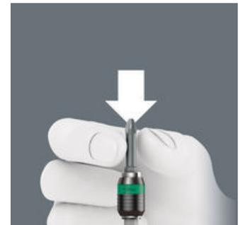
Ohne Betätigung der Hülse kann der Bit in die Aufnahme geschoben werden. Sobald der Bit in der Schraube angesetzt wird, wird die Verriegelung automatisch aktiviert. Der Bit sitzt sicher und wackelfrei.
