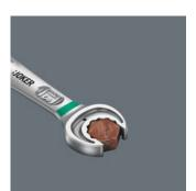
Doppelsechskant-Die clevere Geometrie des Jokers macht die Verbindung mit Schraube oder Mutter formschlüssig – das sitzt. Und die auswechselbare, gehärtete Metallplatte im Maul des Jokers verbeißt sich mit extrem harten Spitzen in die Schraube. Beides verringert die Abrutschgefahr auch bei hohen Drehmomenten.
