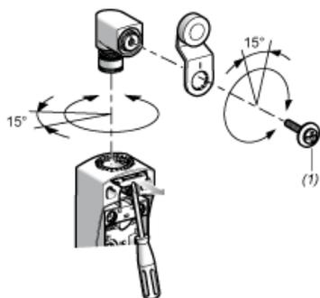
(1) Tightening torque (Min : 1) (Max : 1.5)
