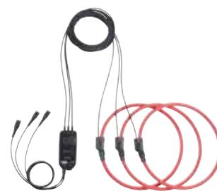
La longueur des capteurs de cette série, jusqu'à 120 cm en standard, permet l'enserrage des câbles de grosse section ou de plusieurs conducteurs simultanément. Les **A110** permettent les mesures de courant jusqu'à 30  $kA_{AC}$ .
