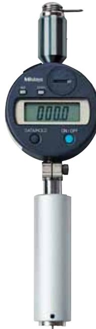
Le corps du modèle long à une forme mince et cylindrique (ø24 x 85 mm).
