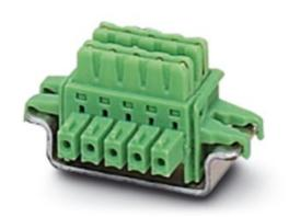
Tragschienen-Busverbinder (T-BUS), 5-polig, zur Brückung der Versorgungsspannung, aufschnappbar auf Tragschiene NS 35/... nach EN 60715
