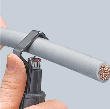
Ansetzen des Werkzeugs für Umfangsschnitt
