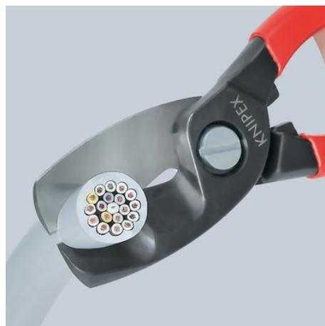
Corte final: Depois de cortar o isolamento com o perfil da frente, o corte da parte metálica do cabos é finalizado no perfil traseiro. Corte inicial no perfil da frente, corte final no perfil traseiro - para tornar o trabalho o mais fácil possível.
