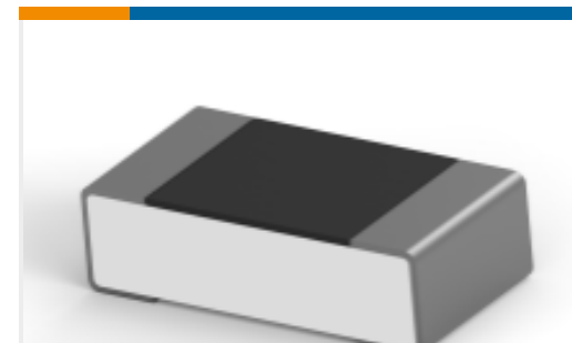
TE Part #2176368-2 RQ 0603 51K1 0.1% 10PPM 1K RL
