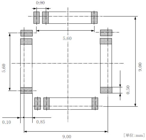
実装基板のフットパターンの設計の際には、実装の容易さ、接続の信頼性、配線の引き回し、 半田ブリッジ発生のないことなどを十分考慮してください。
