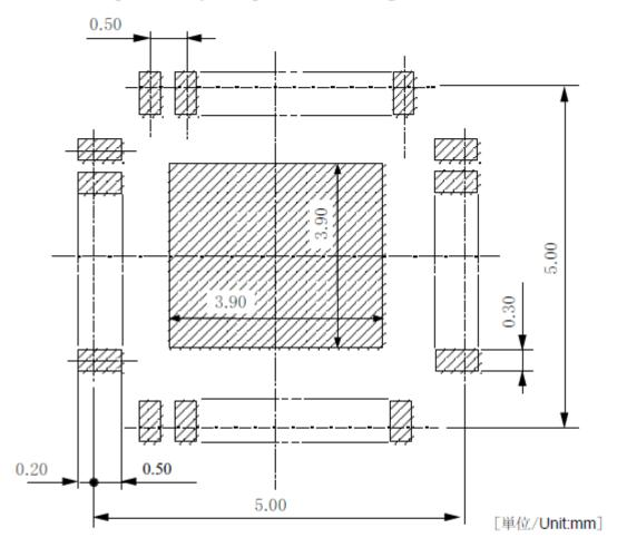
実装基板のフットパターンの設計の際には、実装の容易さ、接続の信頼性、配線の引き回し、 半田ブリッジ発生のないことなどを十分考慮してください。
