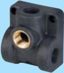
**Durchgangs-Verteiler-Wandscheibe**, Gehäuse Werkstoff PA6 GF 25, Farbe schwarz, mit eingegossenem Messing-Gewinde-Stück am vorderen Abgang, 4 x Innengewinde G 1/2
