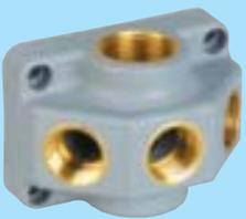
**Durchgangs-Verteiler-Wandscheibe**, Gehäuse Werkstoff PA6 GF 25, Farbe grau (RAL 7001), verdrehsichere Gewindeeinsätze aus Messing bei den drei vorderen Verteilerabgängen sowie dem nach unten abgehenden Durchgangsanschluß (eingangsseitig ohne Messing-Gewindeeinsatz)
