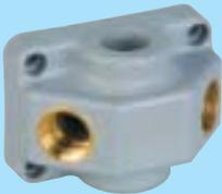
**Durchgangs-Verteiler-Wandscheibe**, Gehäuse Werkstoff PA6 GF 25, Farbe grau, verdrehsichere Gewindeeinsätze aus Messing bei den vorderen Verteileranschlüssen sowie dem nach unten abgehenden Durchgangsanschluß (eingangsseitig ohne Messing-Gewindeeinsatz), 4 x Innengewinde G 1/2
