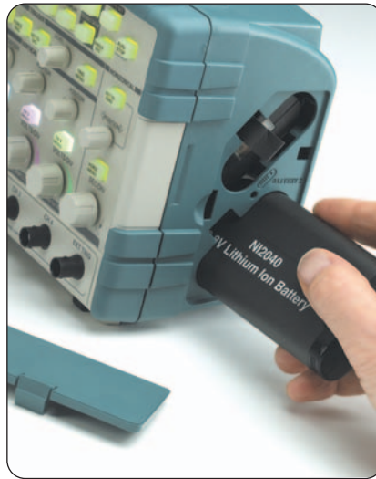
► Nutzen Sie die Vorteile einer praktisch vollständigen Unabhängigkeit von einer externen Stromversorgung mit Akkus, die im laufenden Betrieb gewechselt werden können (Hot-Swap)
