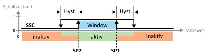
En el modo ventana se establecen los puntos de conmutación SP1 y SP2 para la salida de conmutación. La ventana de conmutación (rango entre SP1 y SP2) y la histéresis deben estar dentro del rango de detección.
