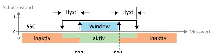
Dans le mode « Window Mode », les points de commutation SP1 et SP2 sont définis pour la sortie de commutation. La fenêtre de commutation (zone entre SP1 et SP2) et l'hystérésis doivent se trouver dans la plage de détection.
