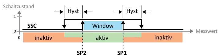
No modo de janela, os pontos de comutação SP1 e SP2 são ajustados para a saída de comutação. A janela de comutação (faixa entre SP1 e SP2) e a histerese devem estar dentro da faixa de deteção.
