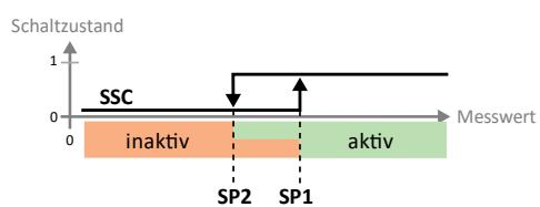
O comportamento de comutação é definido através de um ponto de ligação SP1 e um ponto de desconexão SP2.
