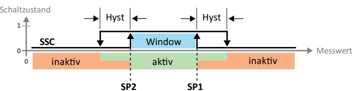
Im Window Mode werden für den Schaltausgang die Schaltpunkte SP1 und SP2 gesetzt. Das Schaltfenster (Bereich zwischen SP1 und SP2) und die Hysterese müssen innerhalb des Erfassungsbereichs liegen.
