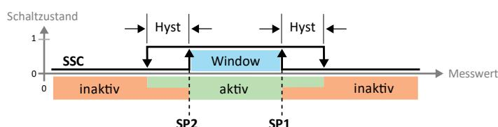
W trybie Window punkty przełączania SP1 i SP2 ustawa się dla wyjścia przełączającego. Zakres przełączania (zakres między SP1 i SP2) i histeraza muszą mieścić się w zakresie pomiaru.
