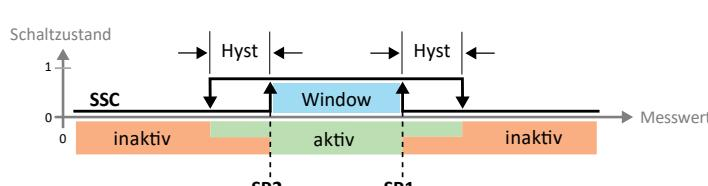
Pencere modunda, anahtarlama çıkıştı için SP1 ve SP2 anahtarlama noktaları ayarlanır.
