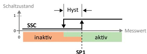
Le comportement de commutation est défini par une valeur limite SP1 et une hystérésis. L'hystérésis doit se trouver dans la plage de détection.
