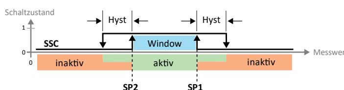
V režimu Window Mode jsou pro spínací výstup nastaveny spínací body SP1 a SP2. Spínací okno (rozsah mezi SP1 a SP2) a hystereze musí ležet v detekčním rozsahu.
