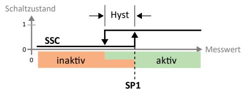
Il comportamento di commutazione viene definito attraverso un valore limite SP1 e un'isteresi. L'isteresi deve rientrare nella gamma di rilevazione.
