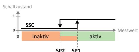
Sposób przełączania definiuje się za pomocą punktu włączenia SP1 i punktu wyłączenia SP2.
