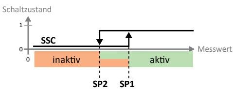
Das Schaltverhalten wird über einen Einschaltpunkt SP1 und einen Ausschaltpunkt SP2 definiert.
