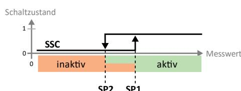
El comportamiento de conmutación se define a través de un punto de conexión SP1 y un punto de desconexión SP2.
