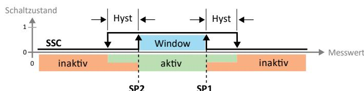
In modalità Window vengono impostati i punti di commutazione SP1 ed SP2 per l'uscita di commutazione. La nastro di commutazione (gamma tra SP1 ed SP2) e l'isteresi devono rientrare nella gamma di rilevazione.
